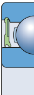
Figura 72 - Rolamento com vedação sem contato do tipo 2RZ.
