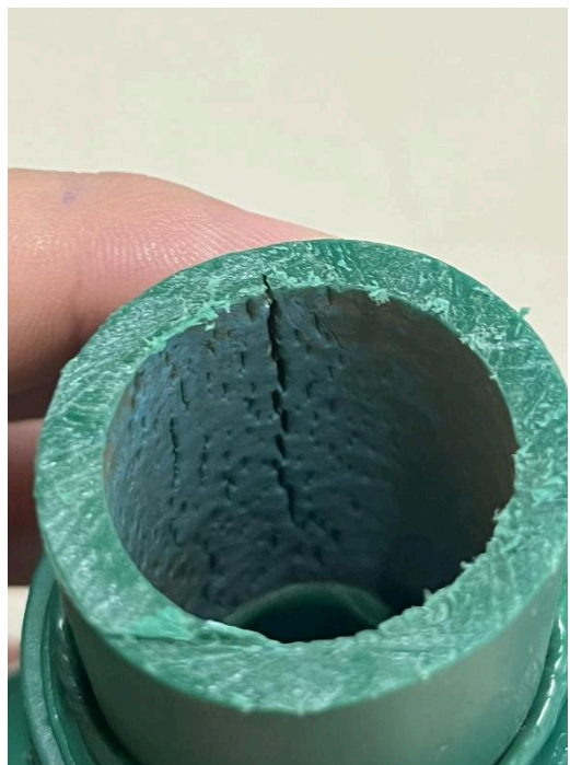
Figura 61 - Conexão com rachaduras internas
