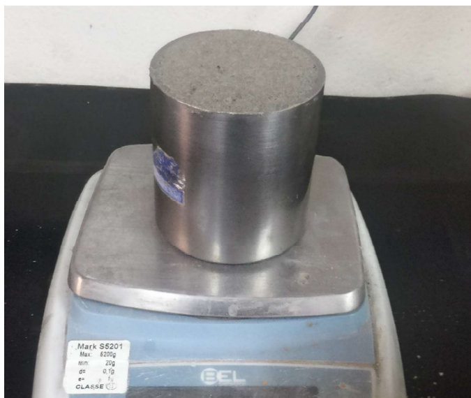
Figura 15 - Medição da densidade de massa no estado fresco
