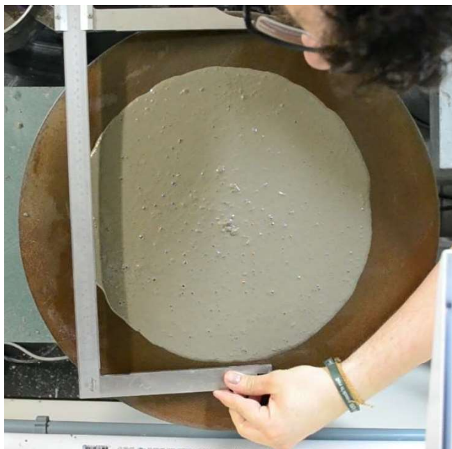
Figura 16 - Medição do espalhamento - mini slump-flow
