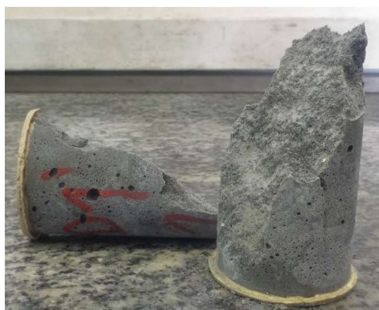
b) Ruptura de corpo de prova ensaiado
