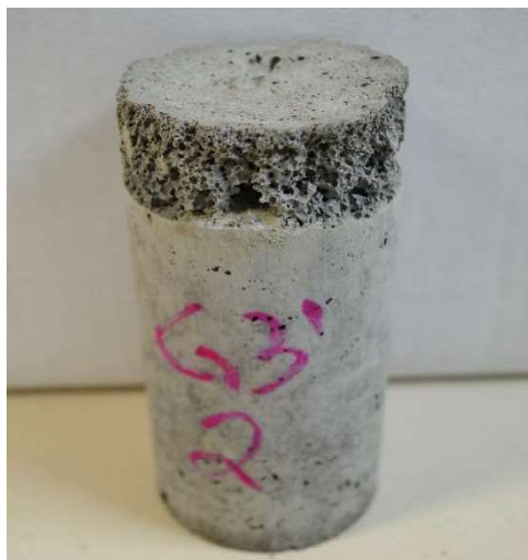
Figura 31 - Exsudação em corpos de prova CCAG
