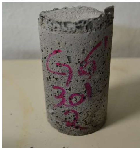
Figura 31 - Exsudação em corpos de prova CCAG
