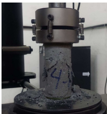
a) Rompimento de corpo de prova
