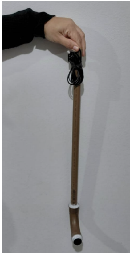
Imagem 20 – Mecanismo móvel para ajuste vertical e rotacional do transdutor
