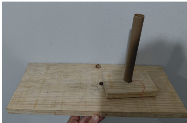
Imagem 19 – Estrutura fixa utilizada para o posicionamento do transdutor
