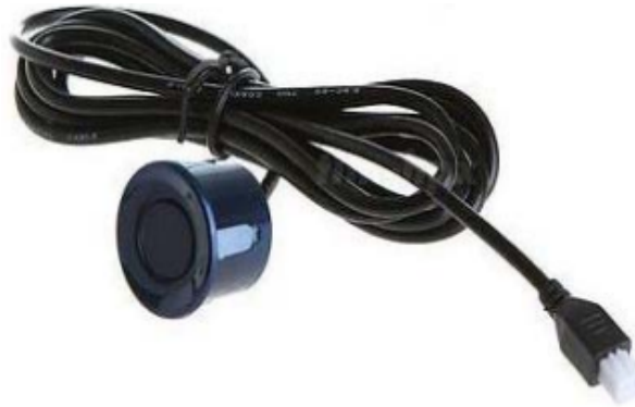
Imagem 7 – Transdutor ultrassônico do módulo JSN-SR04T
