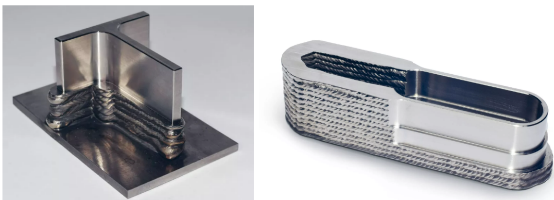
Figura 1 – Exemplos de peças produzidas pelo processo WAAM.
