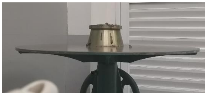
Figura 06 – Ensaio de Índice de consistência
