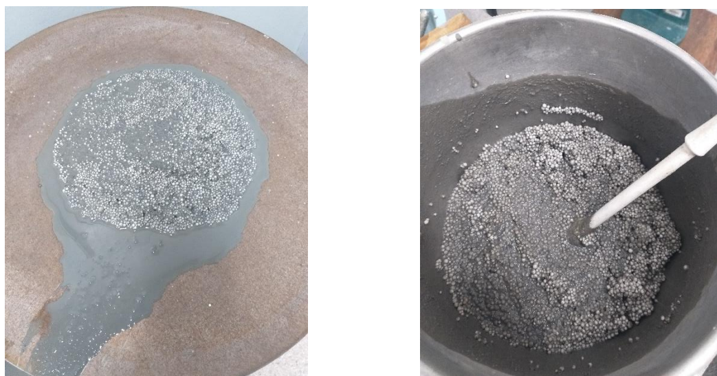
Figura 03 – Ensaio de índice de consistência realizado em pré teste.
