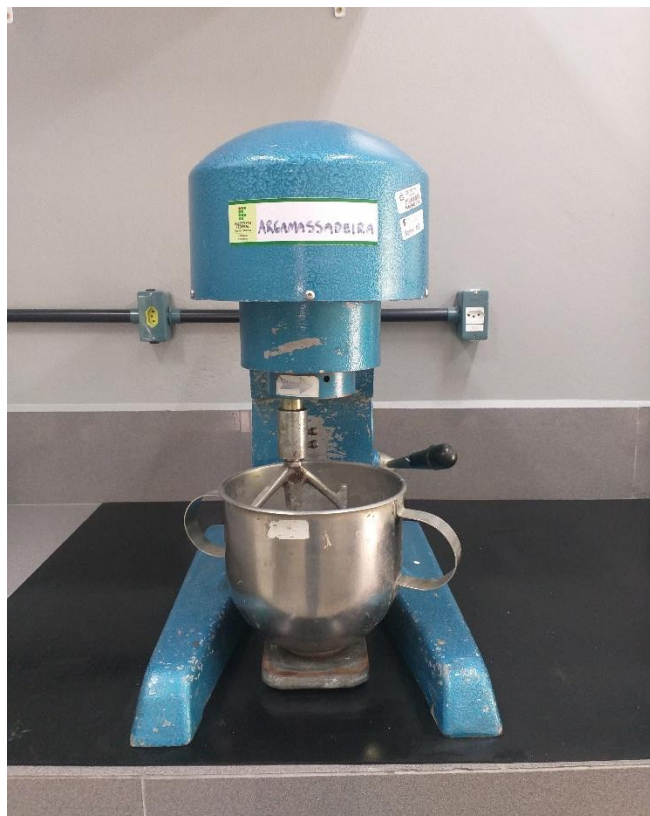
Figura 04 – Argamassadeira utilizada para mistura
