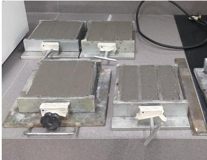
Figura 05 – Cura dos Corpos de prova
