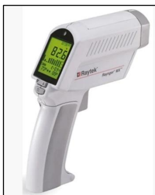
Figura 45 – Termômetro infravermelho Raytek Raynger MX utilizado na avaliação térmica do protótipo.
