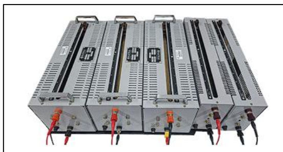
Figura 40 – Conjunto de cargas utilizado nos ensaios experimentais da fonte auxiliar.
