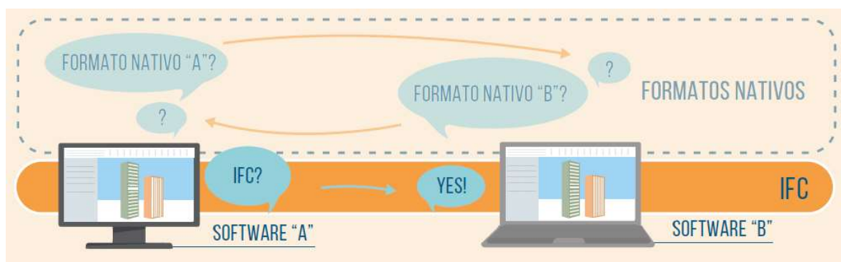
Figura 23 – Softwares diferentes podem se comunicar utilizando formato “neutro”, como o IFC
