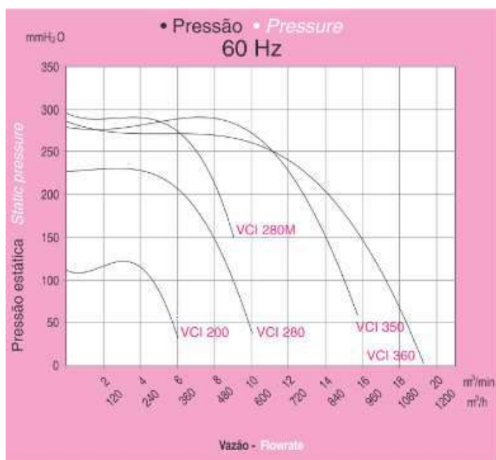
Figura 5 - Curvas características de moto-ventiladores parecidos com o utilizado
