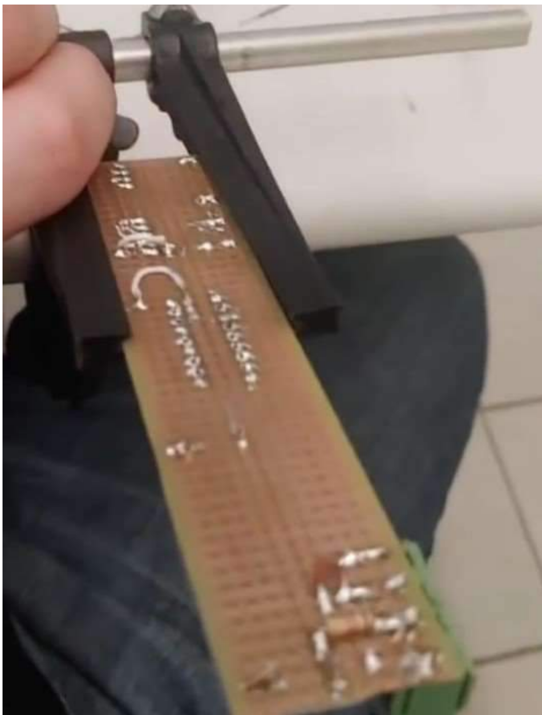
Figura 17 - Solda do Hardware na placa furada
