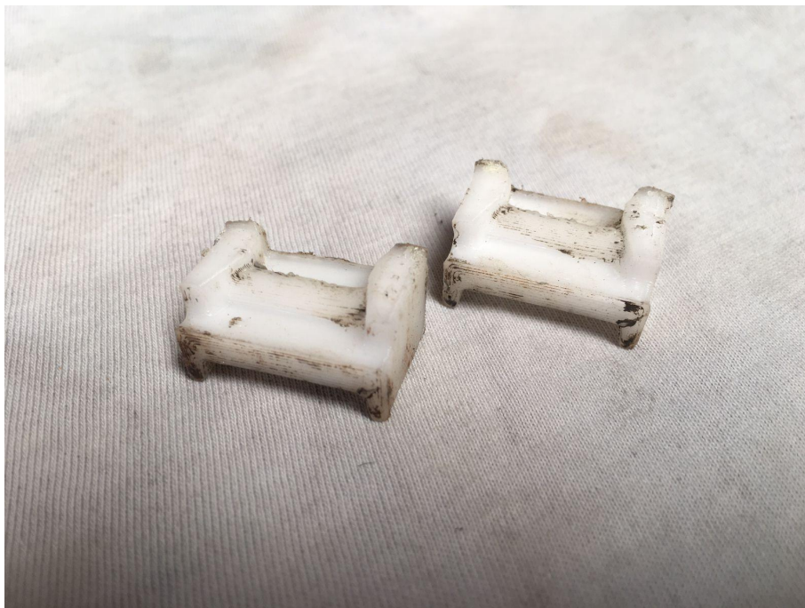
Figura 40 – Defeitos em reparo feito em POM
