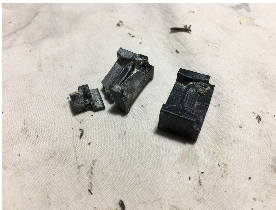
Figura 38 – Defeitos em reparo feito em ABS após testes
