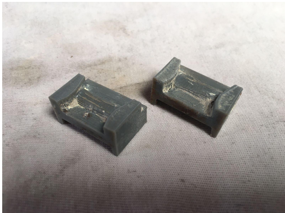
Figura 39 - Defeitos em reparo feito em PET-G
