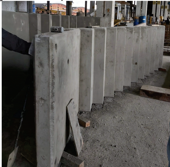
Figura 10 - Escada pré-fabricada de concreto armado
