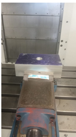
Figura 15 - Primeira execução da peça base da Caixa de Passagem
