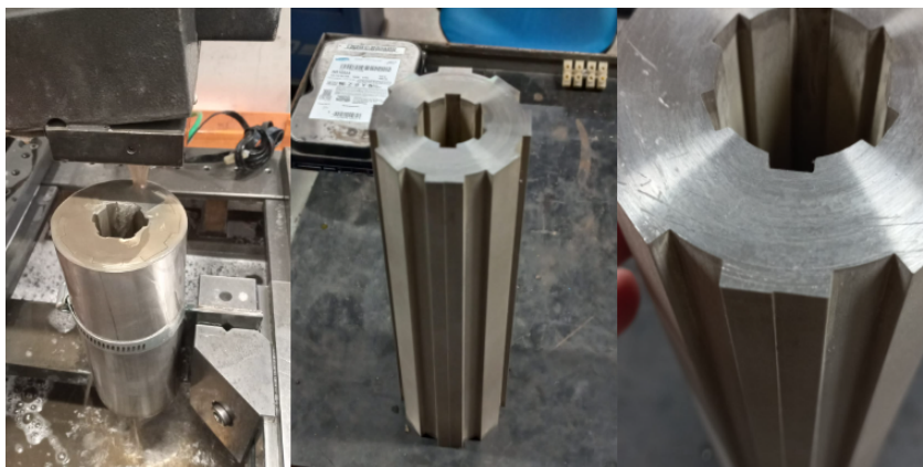
Figura 20 - Segunda tentativa com falha do Eixo do Motor
