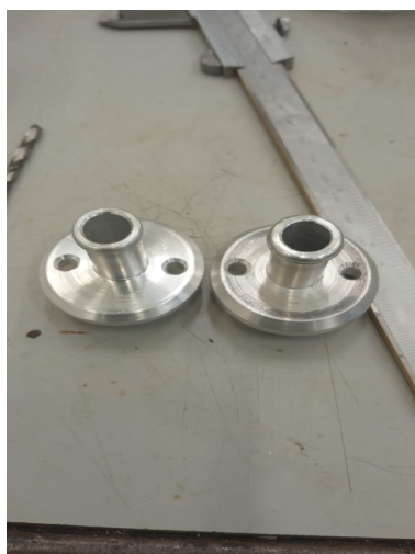
Figura 21 - Flanges Hidráulicas Finalizadas
