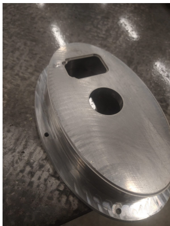
Figura 14 - Caixa de Passagem Finalizada
