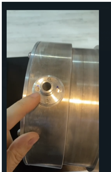
Figura 22 - Erro de Furação das Flanges Hidráulicas
