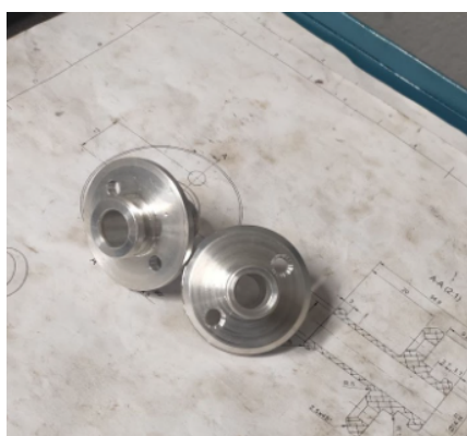
Figura 23 - Flanges Hidráulicas Refeitas
