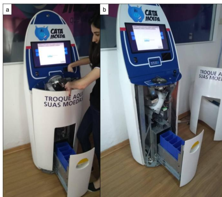
Figura 26 - Passos para a abertura da EFI: a) Deslocamento da carenagem frontal; b) Retirada total da carenagem frontal.
