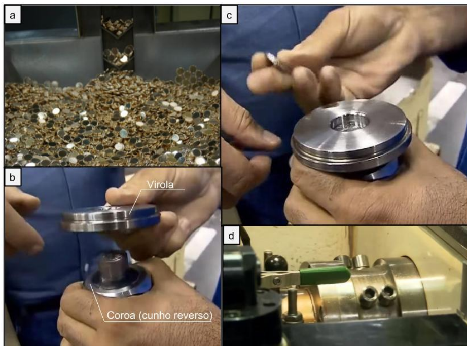
Figura 2 - Processo de fabricação de moedas: a) Inserção das moedas polidas; b) Cunho e virola separadamente; c) Cunho e virola montados; d) Cunhagem das moedas
