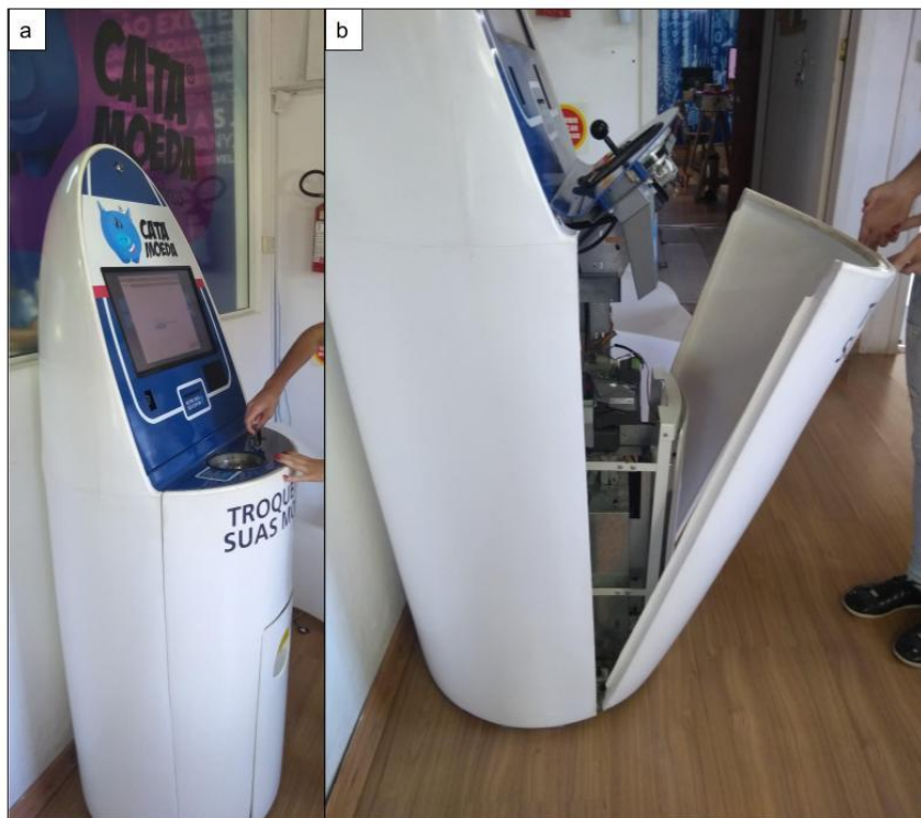
Figura 29 - Passos para a abertura da EFI: a) Destravar a máquina com a chave triângulo; b) abertura final e retirada da carenagem frontal
