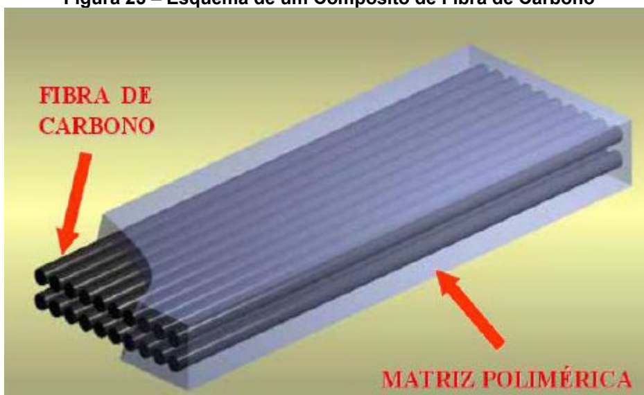
Figura 25 – Esquema de um Compósito de Fibra de Carbono
