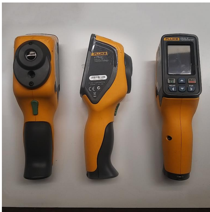
Figura 9 - Montagem vistas da camera térmica VT04A
