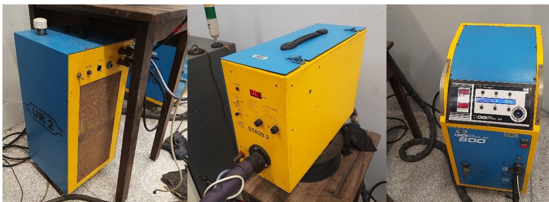
Figura 6 - Refrigeração, alimentador e fonte respectivamente
