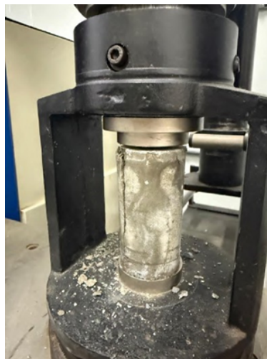
Imagem 8: Corpo de Prova Cilíndrico na Prensa Hidráulica
