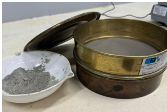
Imagem 9: Materiais do ensaio da ABNT NBR 11579/2012
