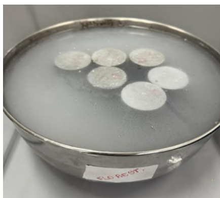
Imagem 6: Corpos de Prova imersos na solução
