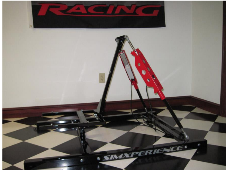
Figura 5 – Simulador 2 DOF com atuadores lineares
