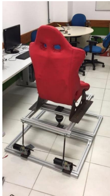
Figura 27 - Montagem mecânica final
