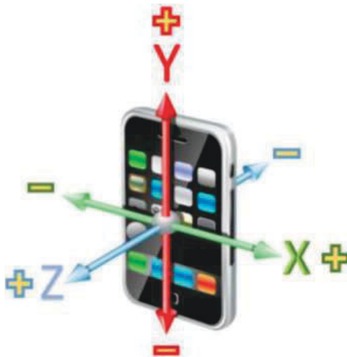
Figura 10 – Eixos que definem as componentes de aceleração de um smartphone
