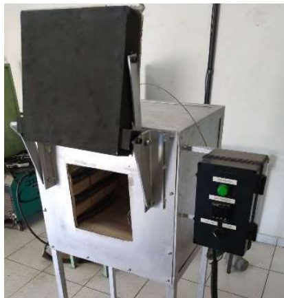
Fig.13 Forno aberto e painel elétrico.
