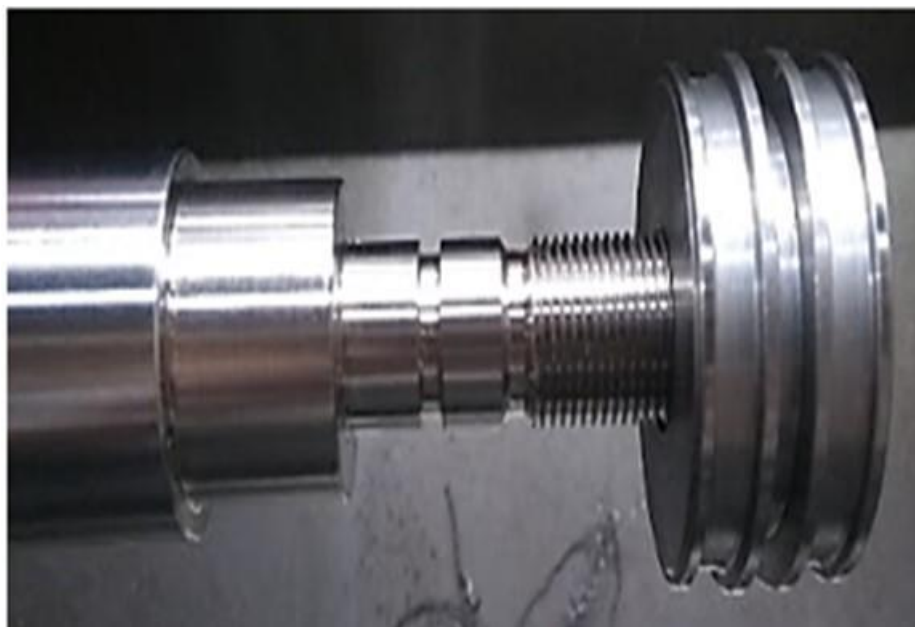
Figura 52 - Êmbolo com interferência de montagem na haste
