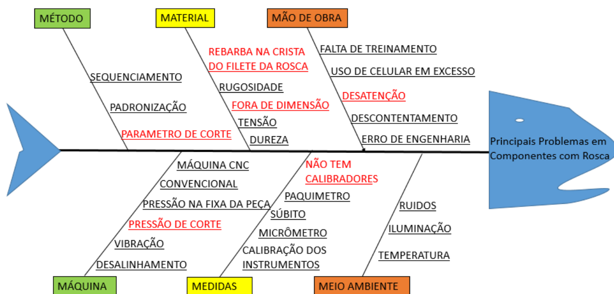
Figura 48 - Diagrama de Ishikawa sobre as possíveis causas de problemas nas roscas.
