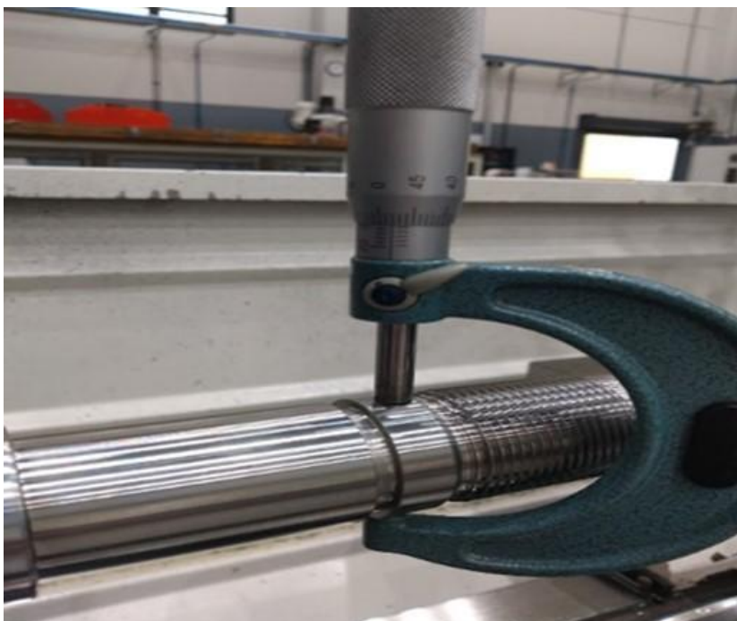
Figura 49 - Verificação do diâmetro da haste no encaixe do êmbolo.
