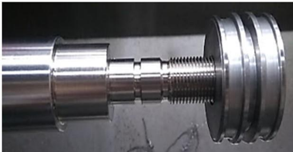
Figura 44 - Exemplo de um êmbolo e a haste de fixação
