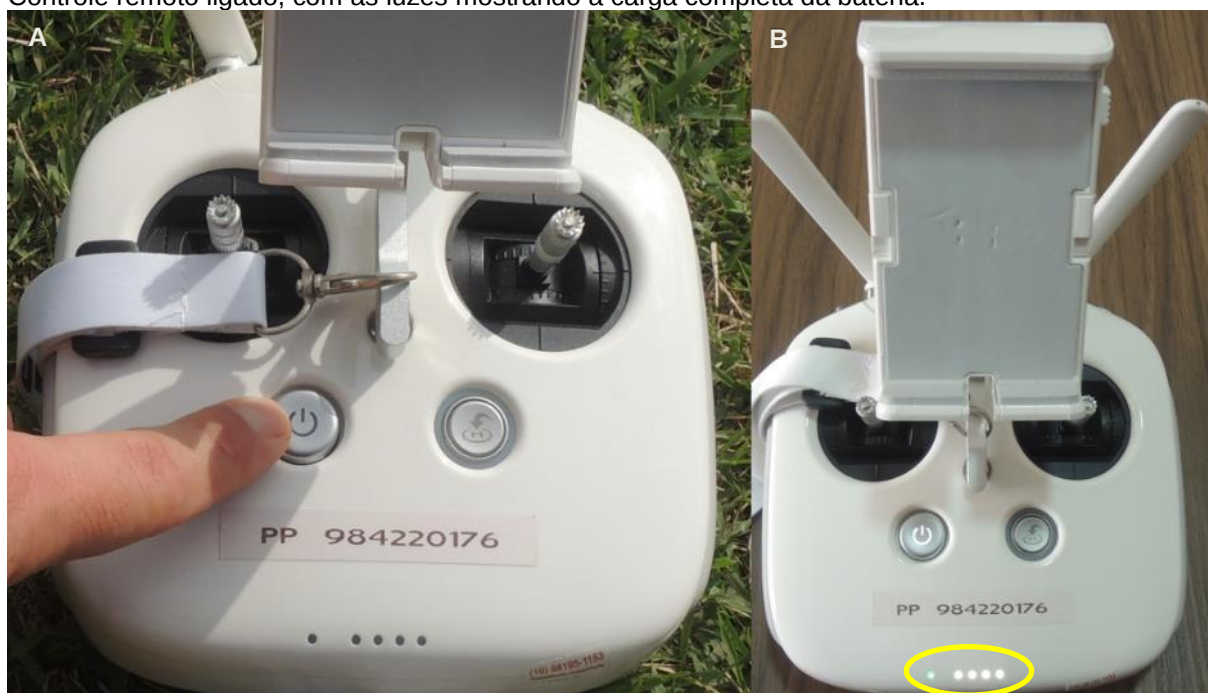
Figura 18 – Ligação do controle remoto. A) Pressionar por alguns segundos o botão “ligar/desligar”. B) Controle remoto ligado, com as luzes mostrando a carga completa da bateria.
