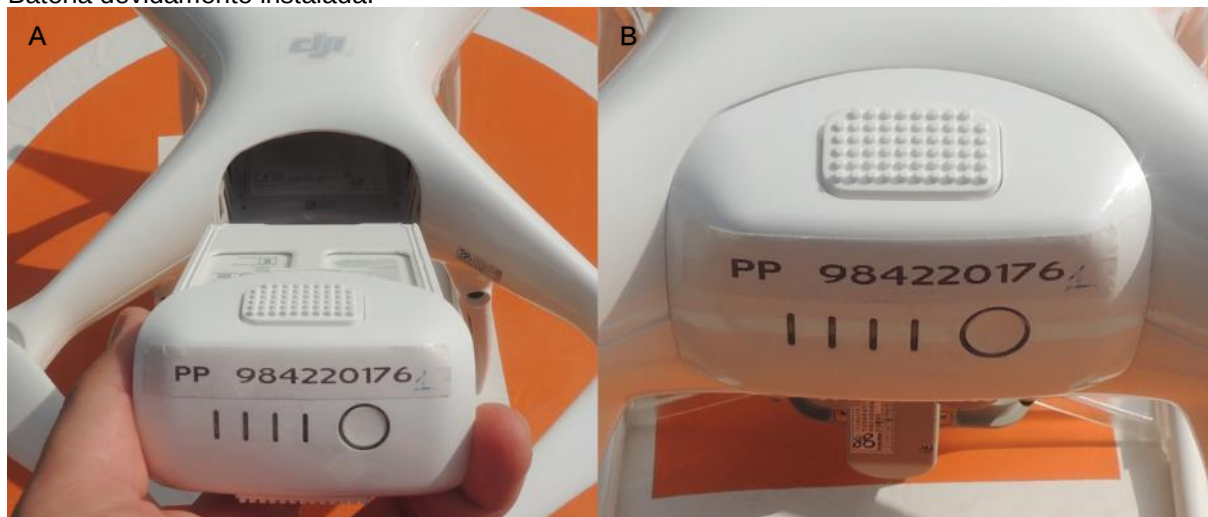
FIGURA 16 – Instalação da bateria no VANT. A) Local onde deve ser feita a instalação (encaixe). B) Bateria devidamente instalada.
