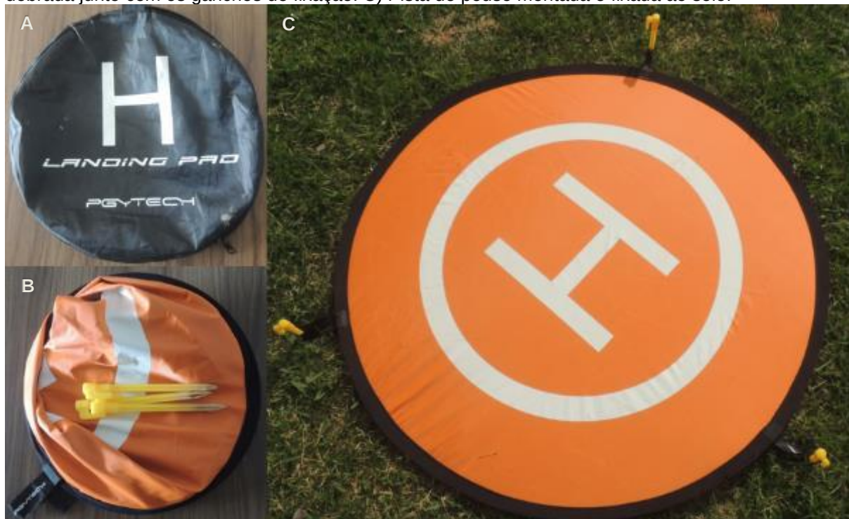
FIGURA 13 – Montagem da pista de pouso. A) Pista na embalagem de transporte. B) Pista de pouso dobrada junto com os ganchos de fixação. C) Pista de pouso montada e fixada ao solo.
