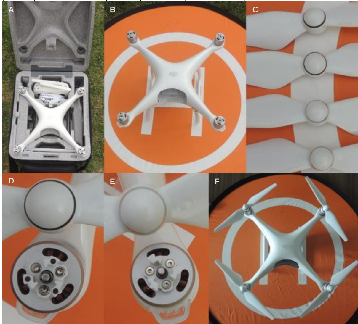
FIGURA 14 – Montagem do equipamento. A) VANT na embalagem de transporte. B) VANT fora da embalagem. C) Dois pares de hélices. D) Hélice com detalhe preto e suporte com detalhes (círculos) pretos. E) Hélice com detalhe prata e suporte branco, sem detalhes. F) VANT com as hélices instaladas.
