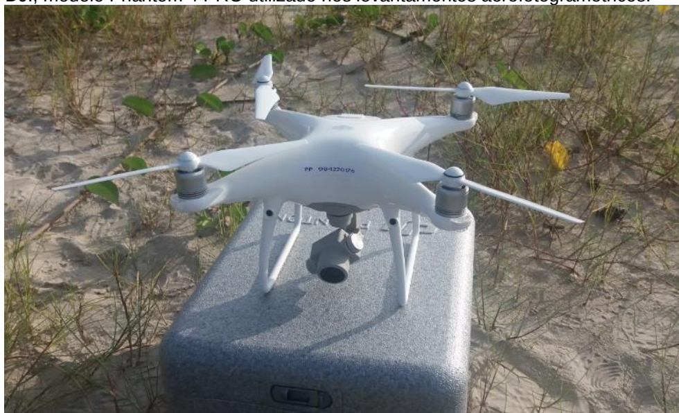
FIGURA 3 – Imagem do veículo aéreo não tripulado (VANT) tipo quadrirotor, marca DJI, modelo Phantom 4 PRO utilizado nos levantamentos aerofotogramétricos.
