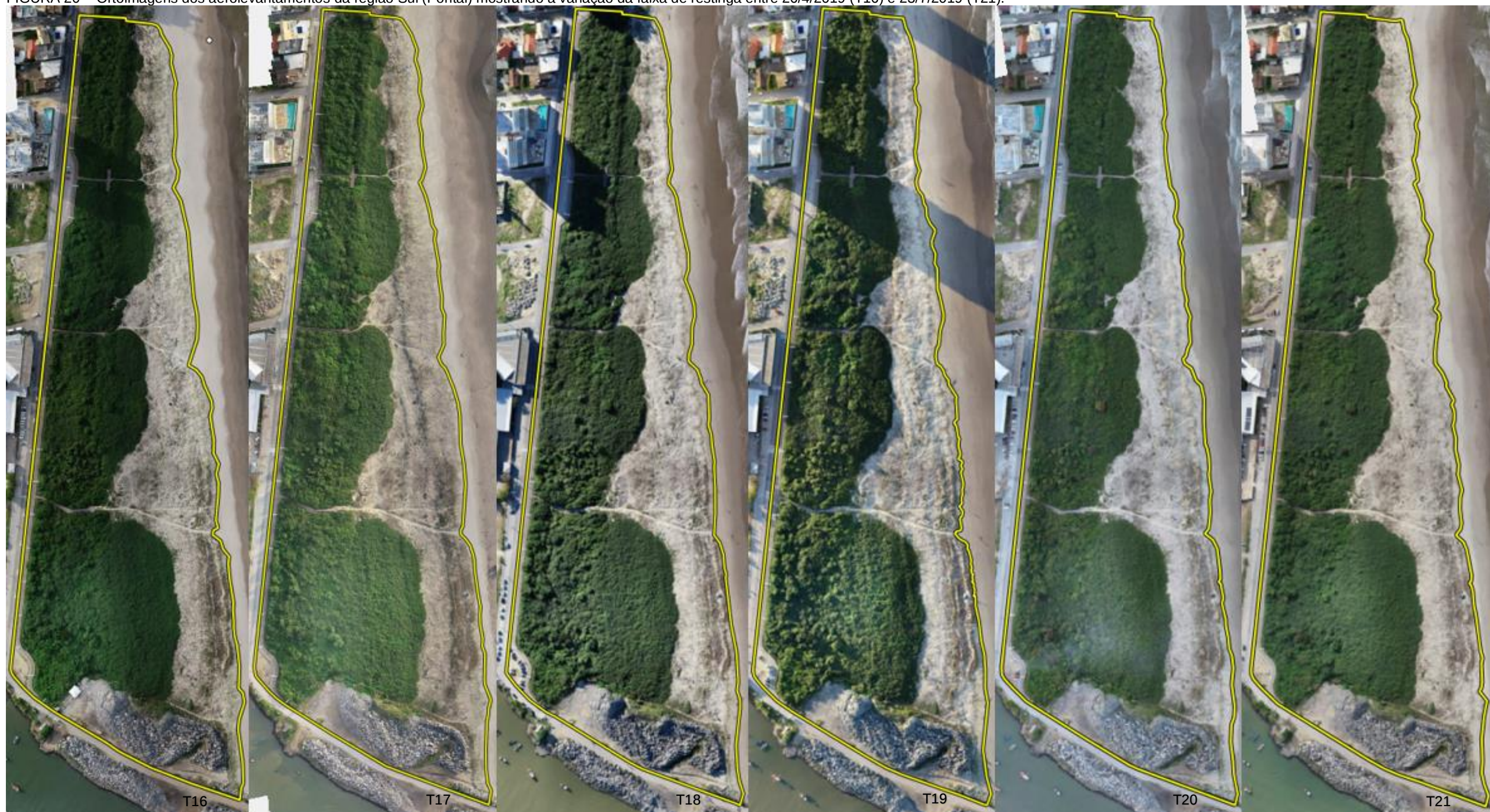
FIGURA 20 – Ortoimagens dos aerolevantamentos da região Sul (Pontal) mostrando a variação da faixa de restinga entre 26/4/2019 (T16) e 23/7/2019 (T21).
