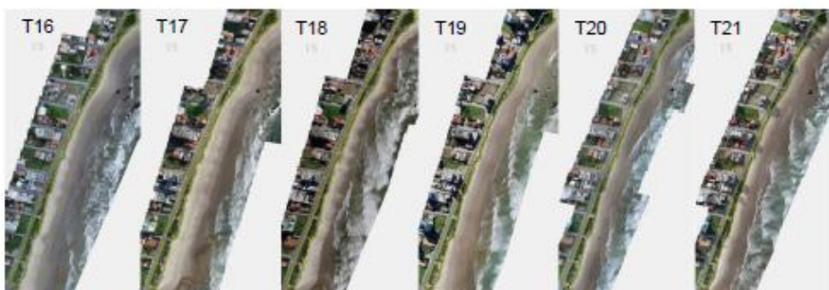
FIGURA 7 – Ortoimagens dos aerolevantamentos da região Norte (praia do Gravata) mostrando a variação da faixa de restinga entre 17/5/2019 (T16) e 23/7/2019 (T21). Fonte: elaborado pelos autores.
