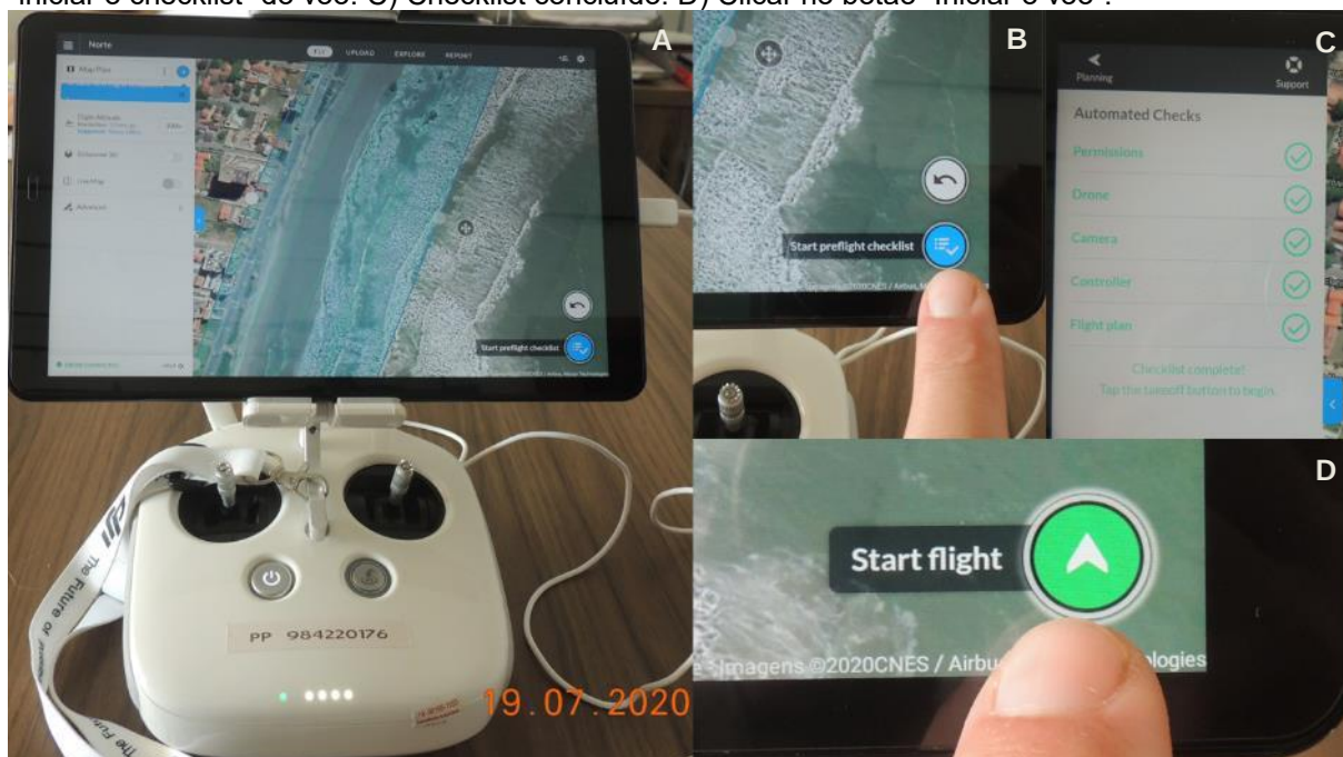
FIGURA 20 – Conexão do tablet com o controle remoto. A) Conexão via cabo USB. B) Clicar no botão “iniciar o checklist” do voo. C) Checklist concluído. D) Clicar no botão “Iniciar o voo”.
