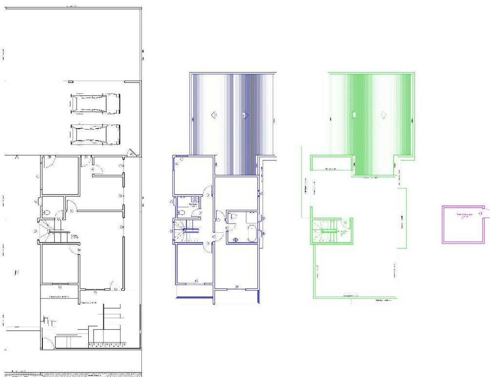
Figura 33 – Arquitetura preparada para lançamento estrutural
