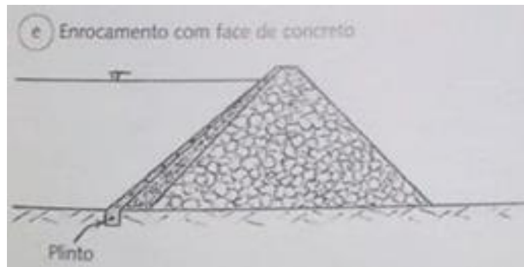
Figura 6- Enrocamento com face de concreto
