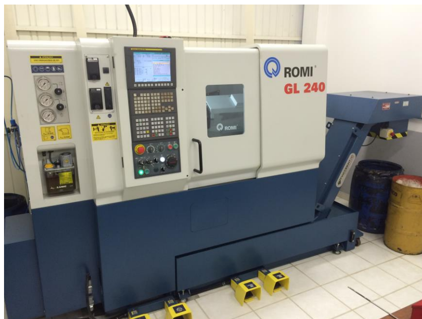
Figura 5 - Torno CNC usado nos ensaios
