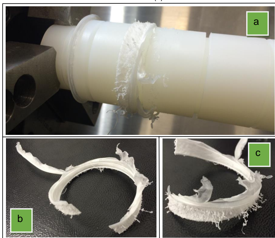
Figura 48 - Ensaio 24: Cavaco preso a peça (a), cavaco em forma de anel 1 (b) e cavaco em forma de anel 2 (c)
