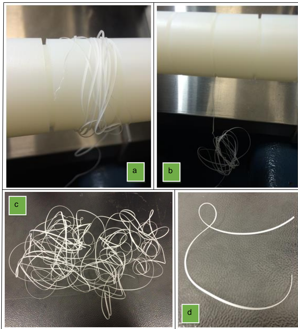
Figura 38 - Ensaio 30: Cavaco enrolado na peça (a), cavaco ainda preso a peça mesmo após o término da usinagem (b), volume de cavaco (c) e cavaco ampliado em 5x (d)
