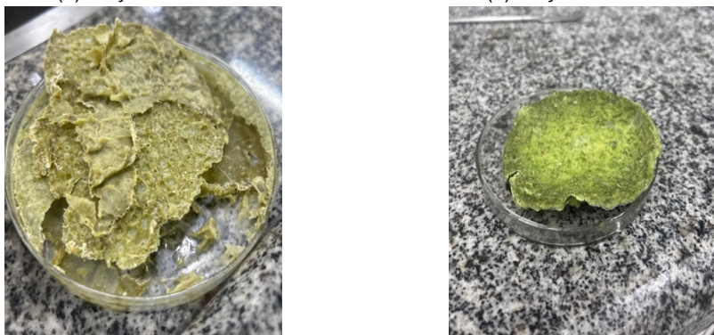
Figura 9 – Processo com adição de polímeros. (a) Adição do PVA. (b) Adição do látex.
