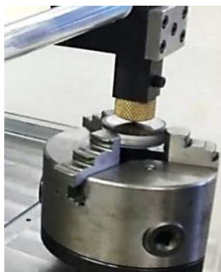
Figura 12 – Fixação do corpo de prova
