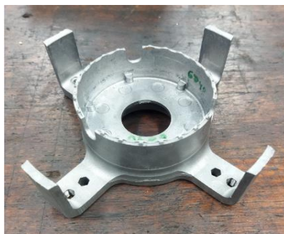
Figura 13 – Peça da máquina onde a pastilha é acoplada
