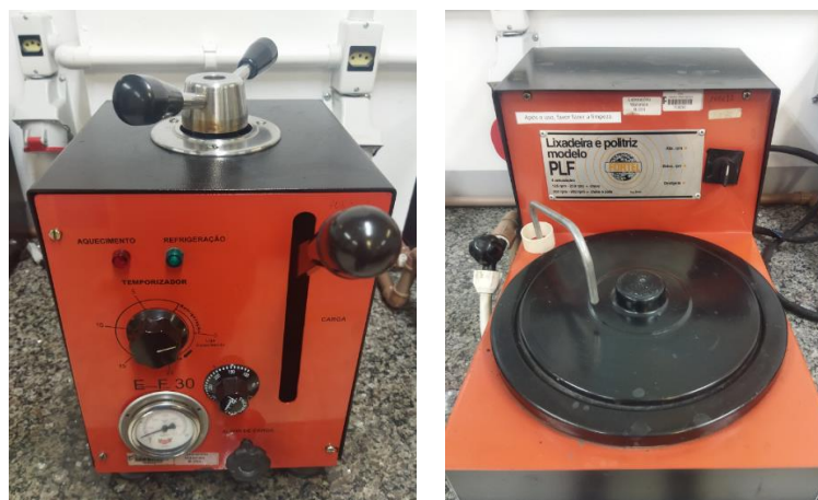
Figura 8 – Prensa térmica para embutimento e Politriz para lixamento e polimento
