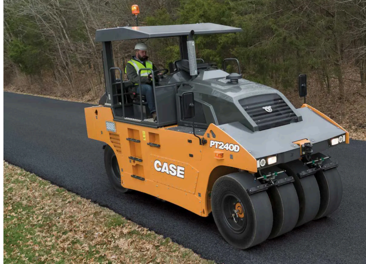
Figura 33 - Caminhão com rolo pneumático
