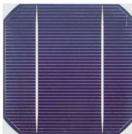
Figura 7 - Célula de silício monocristalino
