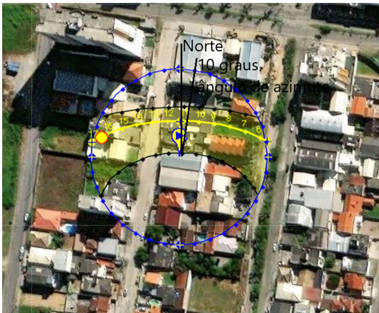
Figura 33- ângulo de azimute da edificação em relação ao norte geográfico
