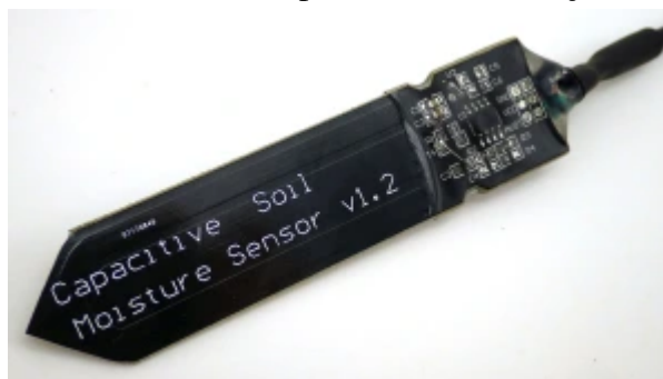
Figura 5 – Sensor de Umidade Capacitivo com Proteção Contra Oxidação.
