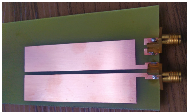
Figura 6 – Sonda coplanar implementada para o presente trabalho.
