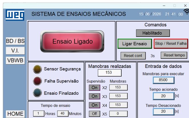
Fig.9. Tela da IHM com ensaio em operação (ligado)
