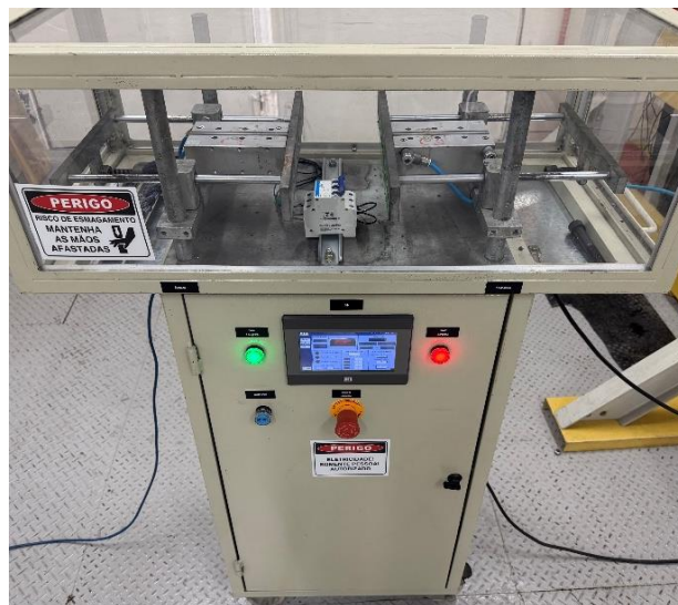
Fig. 7. Instalação da IHM e substituição do CLP TPW03. Fonte: Autoria própria.
