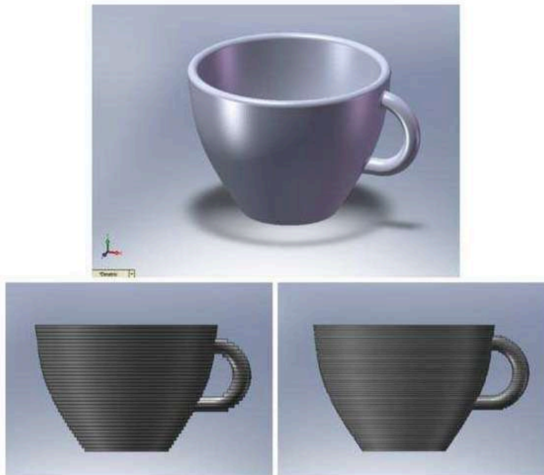
Figura 10 - Diferença na altura de camadas do processo FDM.
