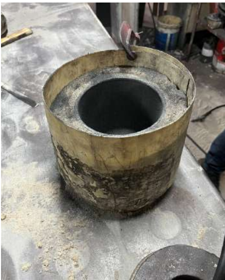
Figura 34 - Modelo pronto para compactação da área na parte interna.
