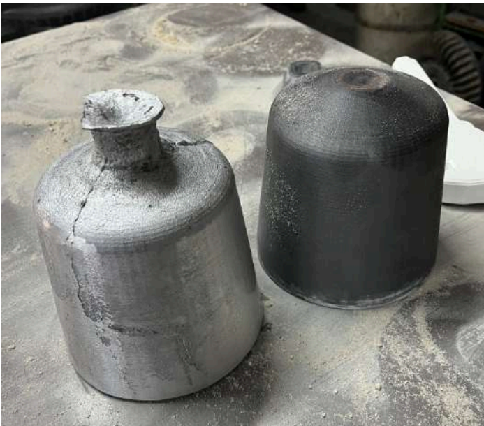
Figura 38 - Comparação entre a peça fundida e o modelo impresso
