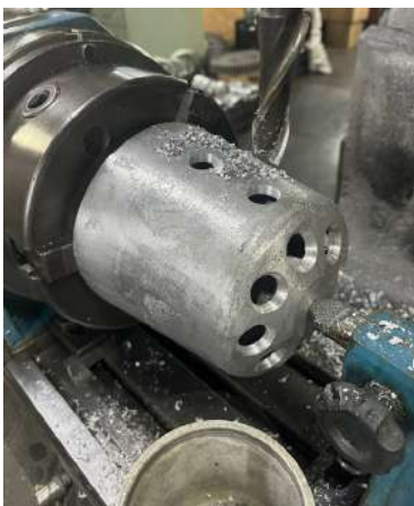
Figura 40 - Processo de furação para os dedos depenadores.
