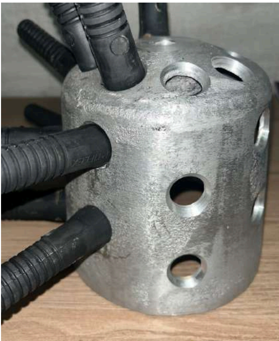
Figura 45 - Superfície do copo fundido.
