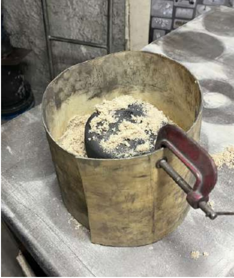
Figura 33 - Modelo inserido na caixa de moldagem durante a compactação da areia.
