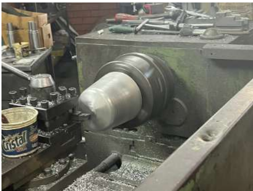
Figura 39 - Processo de torneamento do copo fundido.
