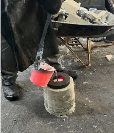
Figura 37 - Derramamento de alumínio no molde
