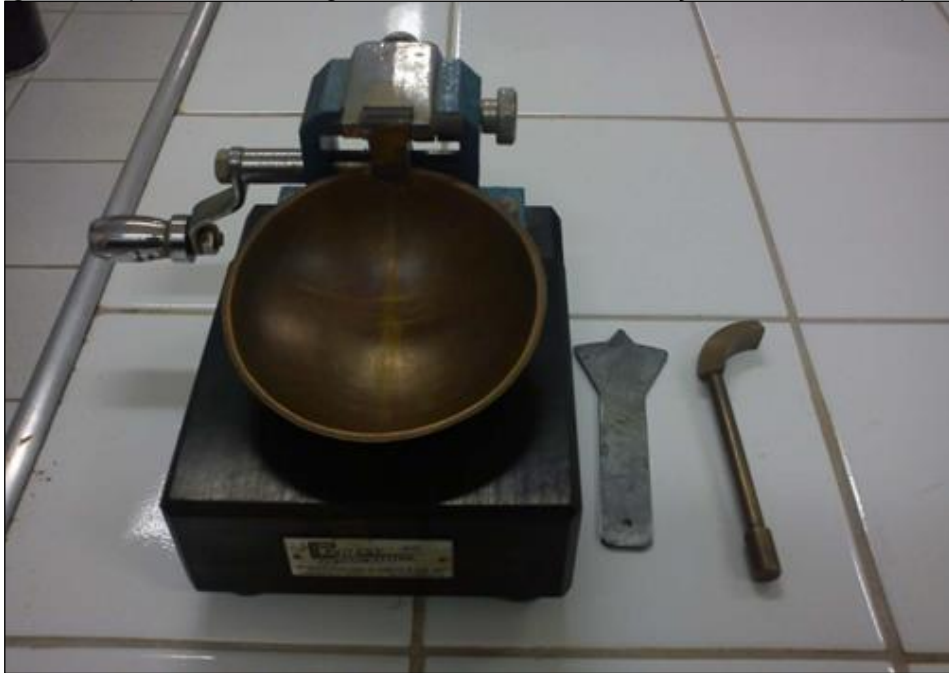
Figura 9 - Aparelho de Casagrande utilizado na determinação do limite de Liquidez
