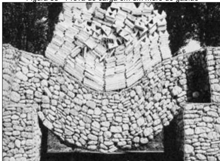
Figura 53 - Prova de carga em um muro de gabião
