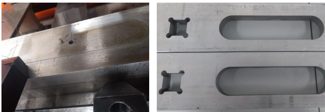
Figura 23 - Corte eletro erosão a fio e seus resultado final
