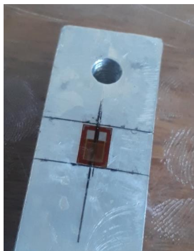
Figura 16 - Colagem dos extensômetros
