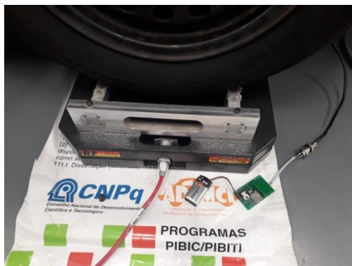
Figura 26 - Procedimento de variação da pressão dos pneus
