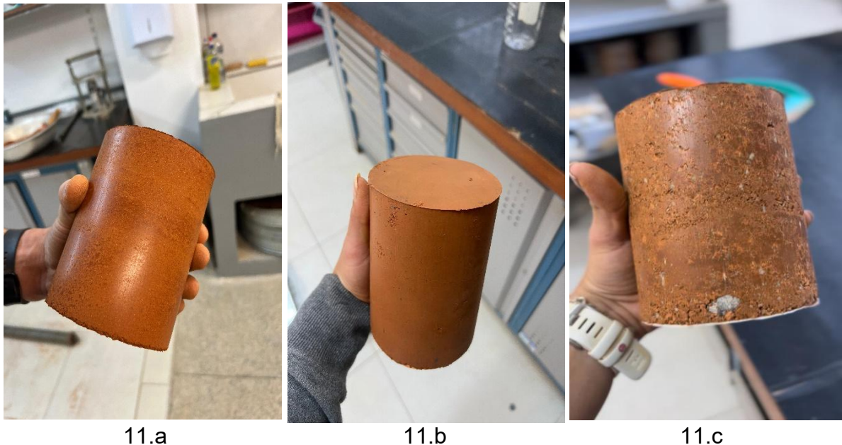
Figura 11: Corpos de prova do ensaio de compactação de solo
