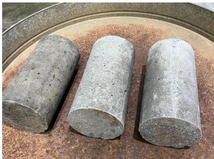
Figura 9 : Corpos de prova de concreto para obtenção do RCD
