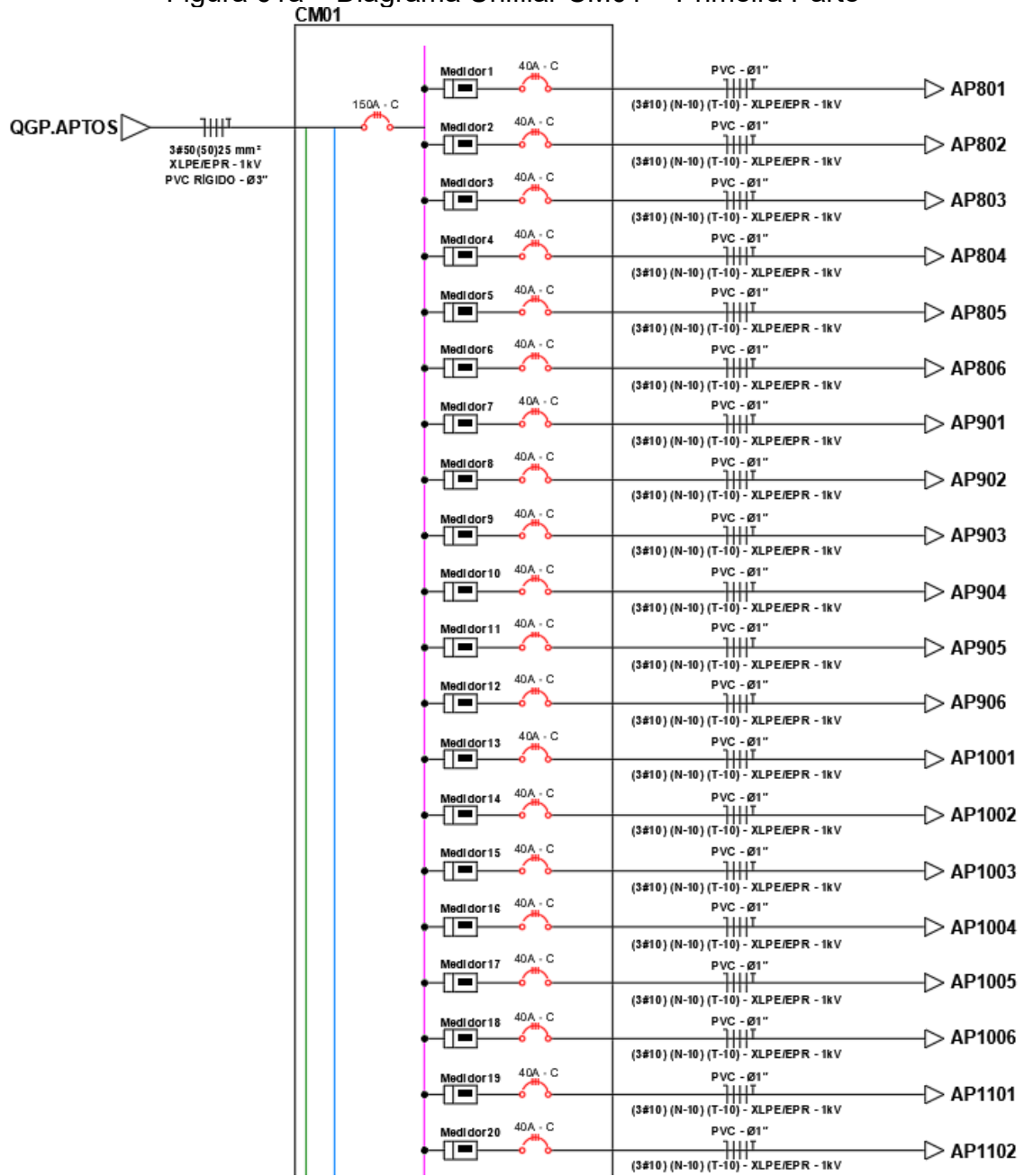
Figura 61a – Diagrama Unifilar CM01 – Primeira Parte
