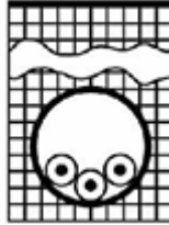
Figura 23 – Método D: Eletrodutos enterrados.
