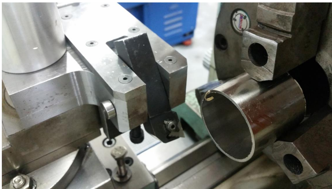
Figura 20 - Dispositivo depois de acionado gerando a amostra com cavaco ainda vinculado a peça.
