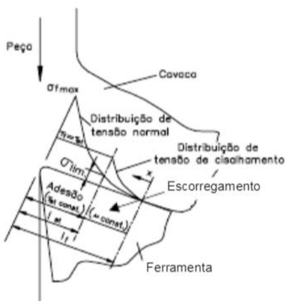
Figura 4 - Modelo de distribuição de tensões em usinagem
