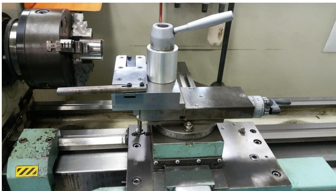
Figura 29 – Dispositivo Quick Stop desenvolvido fixo no Torno.
