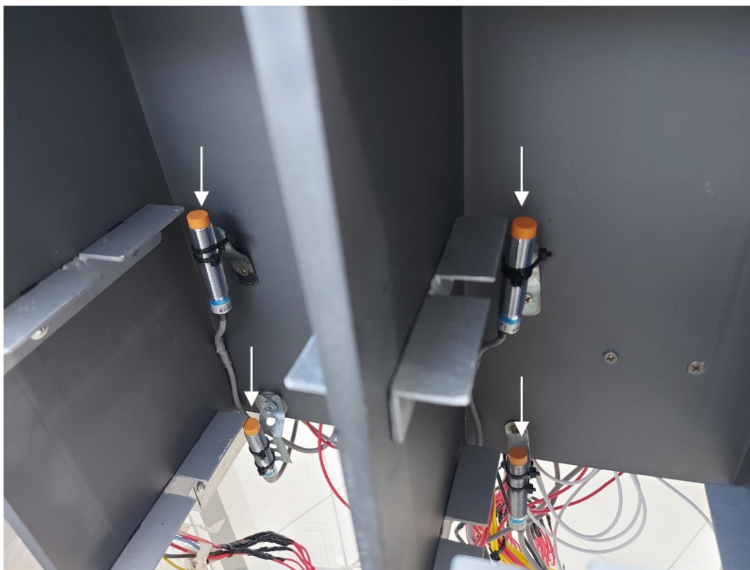
Figura 27 – Sensores indutivos posicionado sob os suportes das vagas
