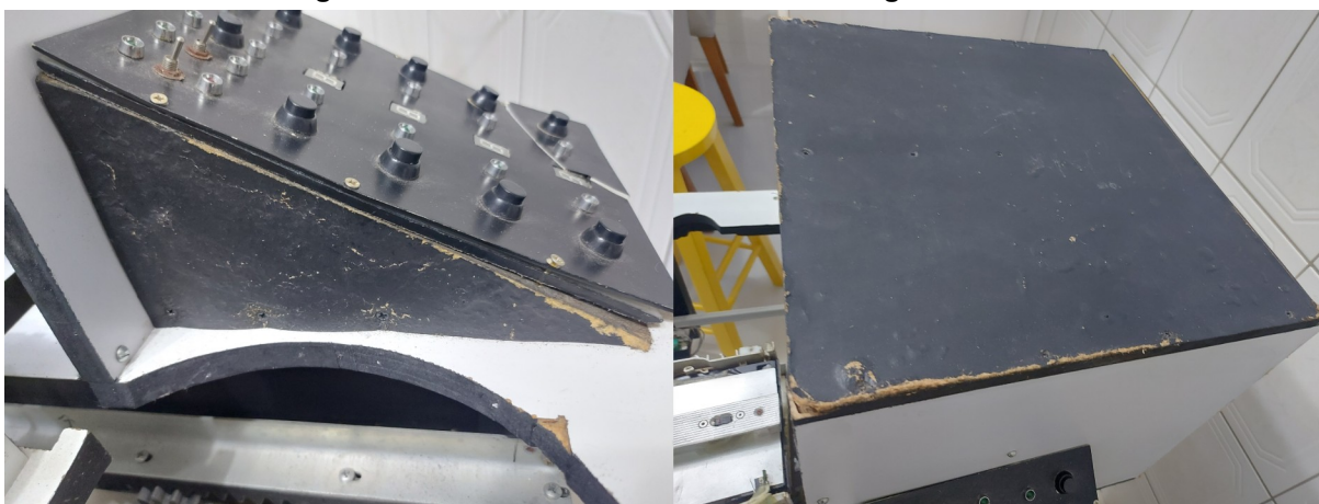
Figura 15 – Estruturas de madeira com irregularidades
