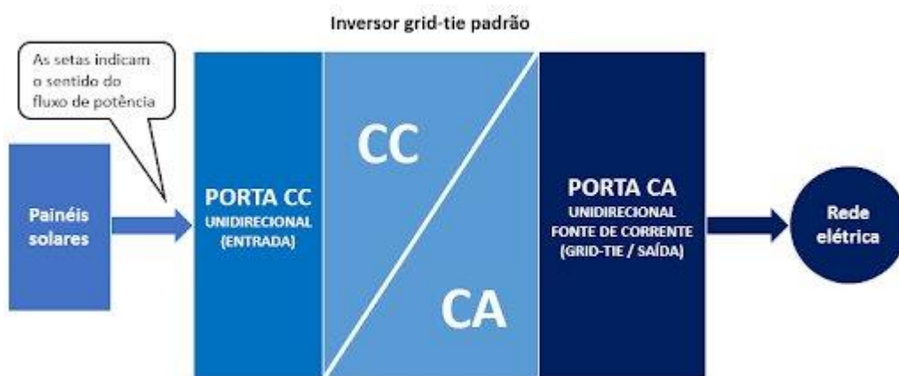
Figura 3: Funcionamento do inversor on-grid .
