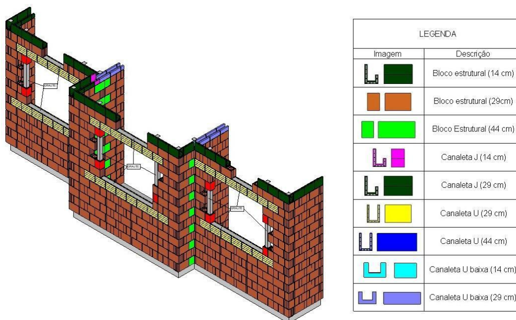
Figura 10 - Vergas e contravergas preenchidas com graute
