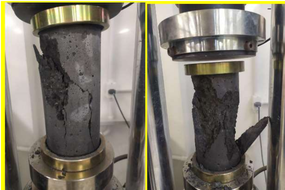
Figura 6 - Ensaio de compressão axial do concreto
