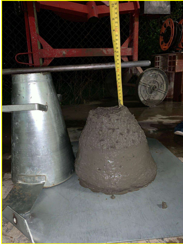
Figura 5 - Ensaio de abatimento do tronco cone.
