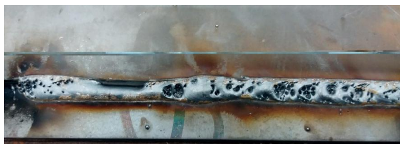
Figura 26 – Em (a) o problema de porosidade no cordão de solda e em (b) a solução utilizada
