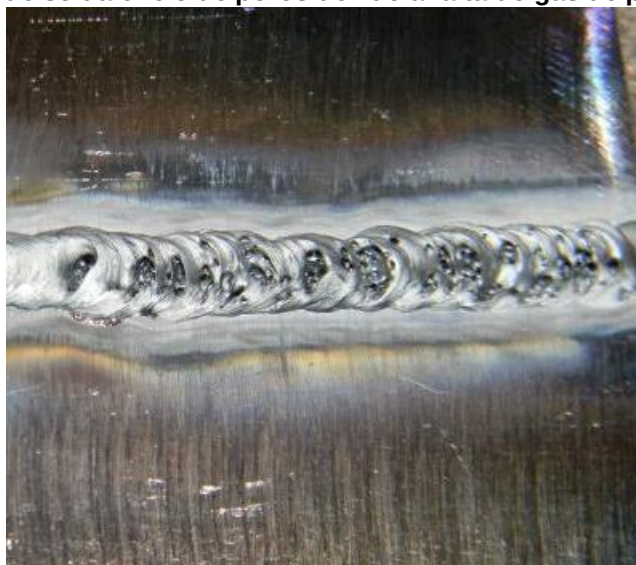
Figura 10 - Cordão de solda cheio de poros devido à falta de gás de proteção
