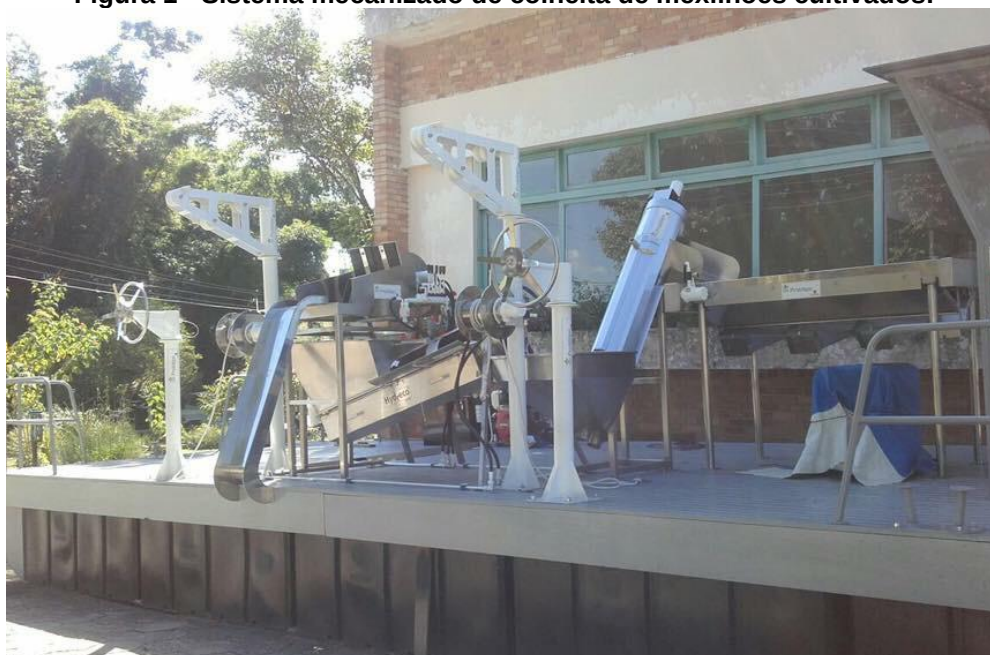
Figura 1 - Sistema mecanizado de colheita de mexilhões cultivados.
