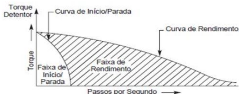
Figura 13 – Gráfico da relação de torque e velocidade do motor de passo
