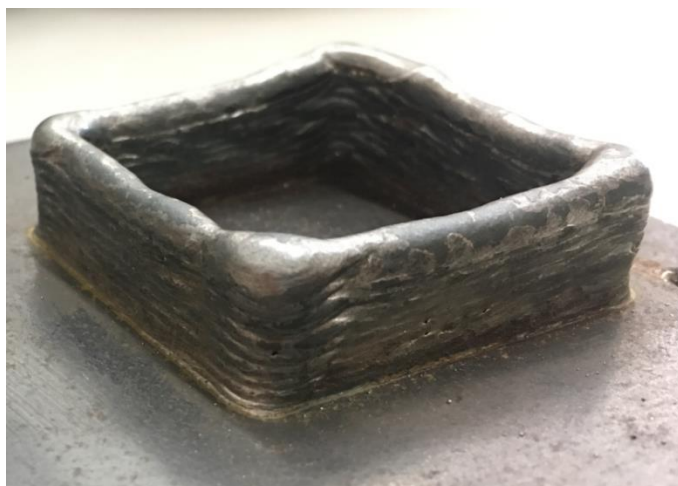
Figura 35 - Construção com estratégia quadrada com 10 camadas
