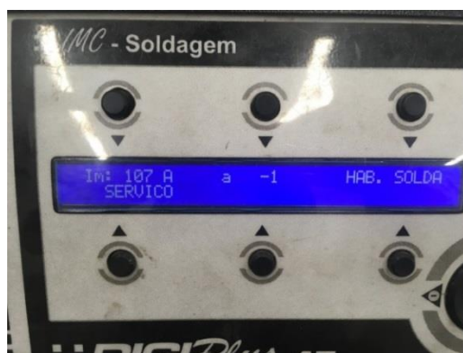
Figura 9 - Display fonte no modo convencional sinérgico
