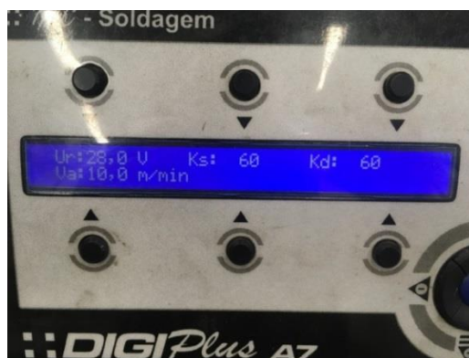
Figura 8 - Display no modo convencional normal
