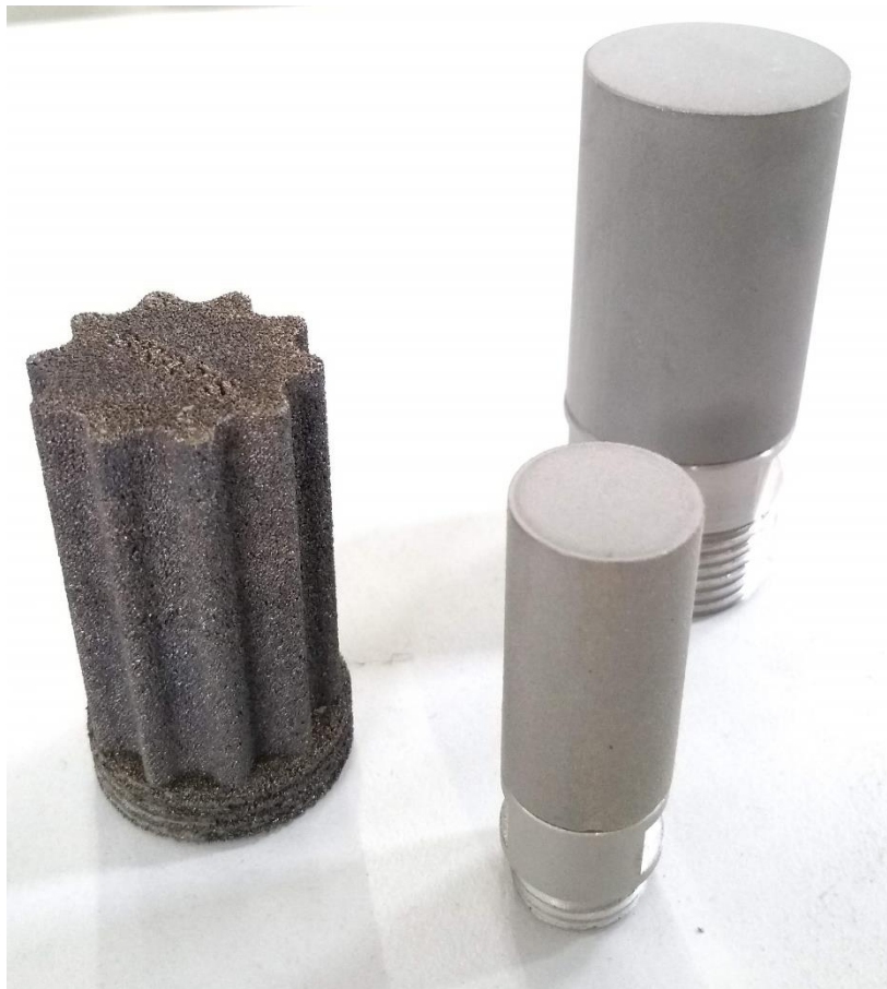
Figura 20 – (À esquerda) Filtro metálico fabricado a partir do processo de SLM após a conclusão do trabalho. (À direita) Filtros metálicos fabricados por processo de sinterização convencional.
