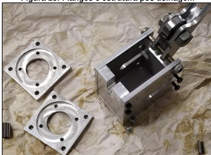
Figura 15: Flanges e estrutura pós usinagem
