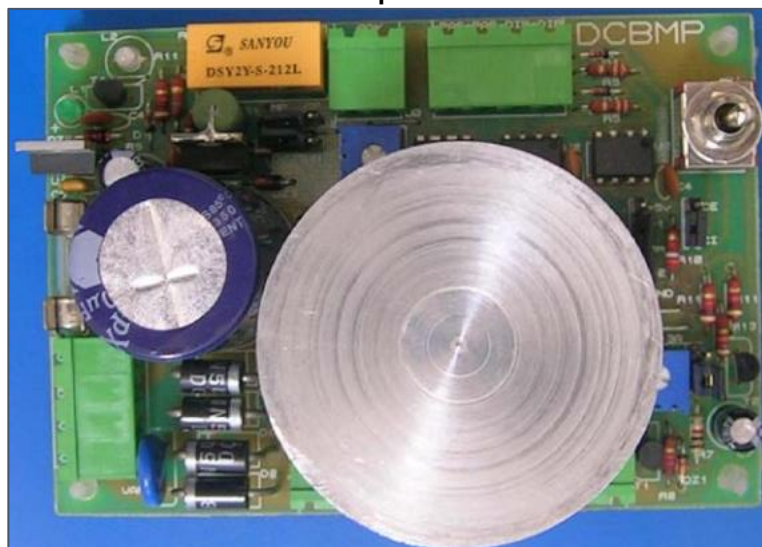
Figura 28: Driver de corrente didático para acionamento de motores de passo
